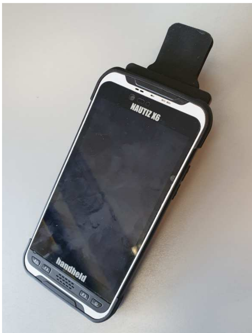
Erfassungsgerät für Milchproben: Nautiz X6 mit RFID Scanner
